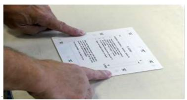
電動ドリルを使用してカッティングプレート上の「A」とマークされた8つ位置に5.0mm または6.5mm の穴を開けます。
