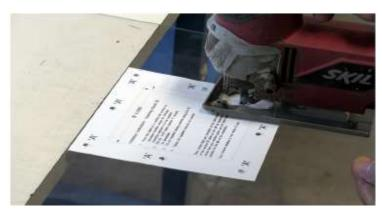
4. カッティングテンプレートの残りの部分を取り除き、必要に 応じて穴とエッジのバリを取り除きます。
