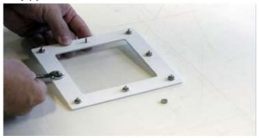
6. 切り抜いた穴にポリマーフィルムのフロントプレートを置きます。
