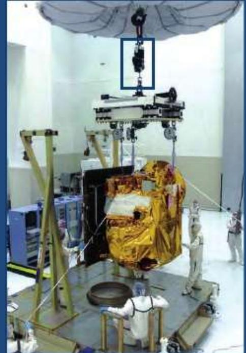
ハイドラセットは、クレーンやホイストに取付け、定格容量内の負荷を12インチ（30.5cm）の範囲内で0.001インチ（0.025 mm）以下で上下移動ができます。また定格容量内の物体の重量を測定することも可能です。重機の組み立て時に、貨物を正確な位置に配置することができます。
