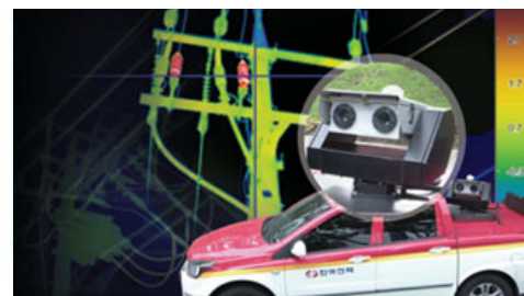
配電路自動診断システム
